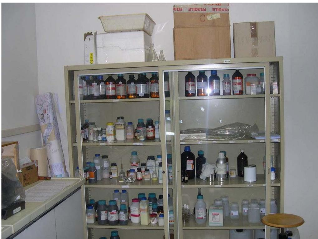
(3.5.5 V) Le sostanze chimiche pericolose contenute in recipienti fragili non possono cadere accidentalmente (tuttavia l'armadio non è conforme ai requisiti previsti per i contenitori di liquidi infiammabili)
